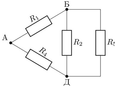
Дополнительно соединим точки **Б** и **Д** и измерим сопротивление  $R_x$  между ними и точкой **А**.
